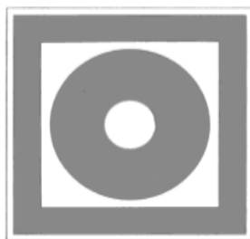
Кнопка включения установок (систем) пожарной автоматики
