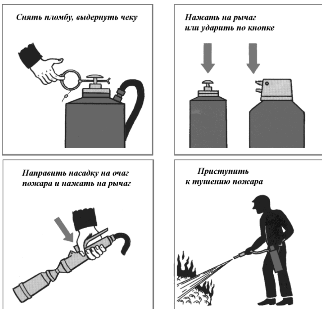
Рис. 9. Приведение в действие воздушно-пенного огнетушителя (плакат)
